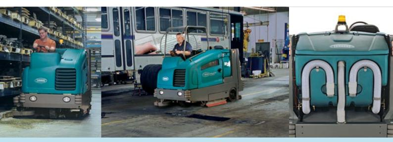
La barredora-restregadora completamente integrada M20 está diseñada para una limpieza industrial continua y permite restregar, barrer o hacer las dos cosas al mismo tiempo.
